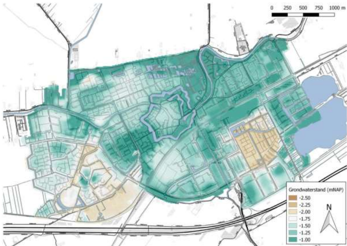
Figuur 3: De berekende GHG in m-NAP (grondwater hoog).
